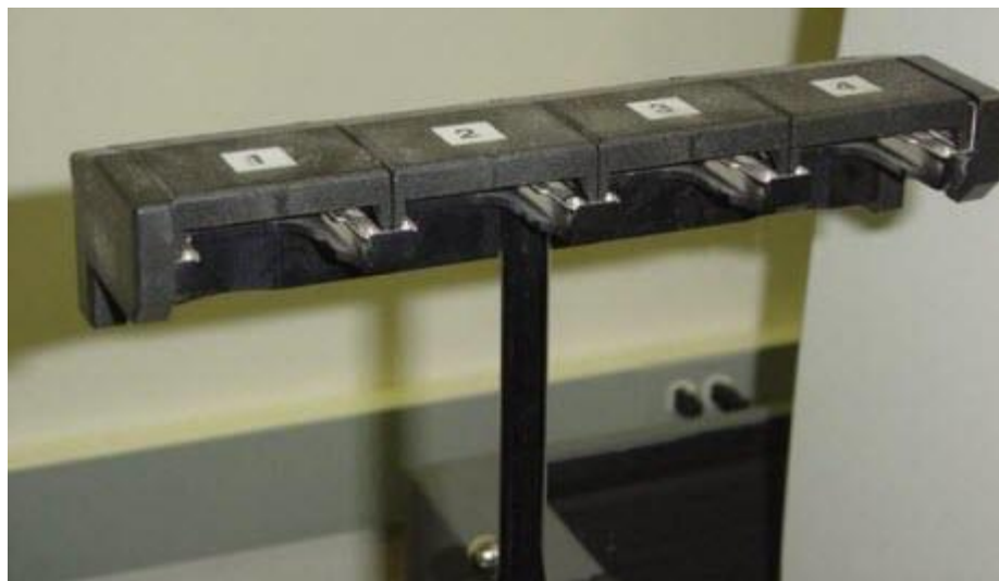
Un changeur de stylet Renishaw SP600 (SCR600)
