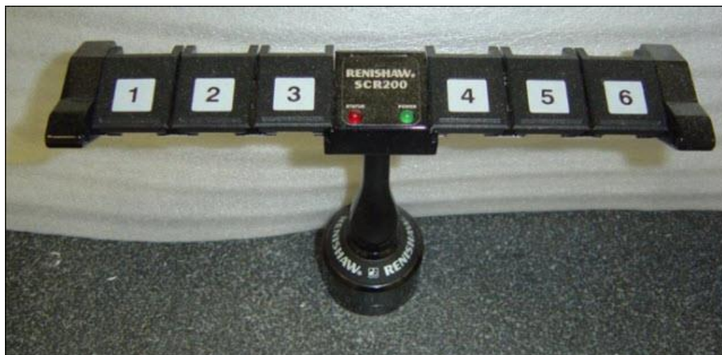
Support de changeur de palpeur TP200
