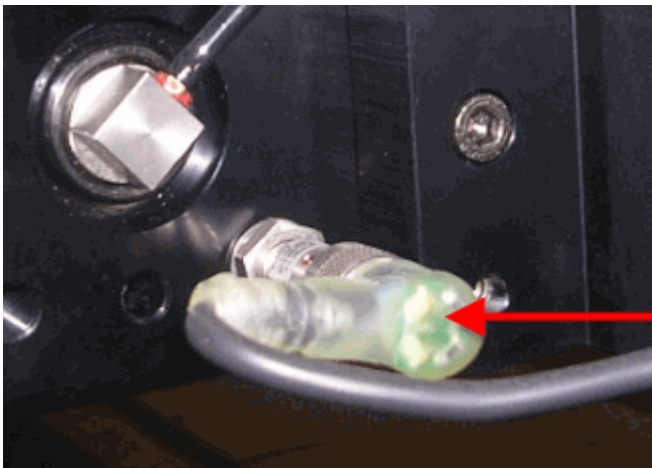
Connexion solénoïde avec des lumières LED vertes et ambres
