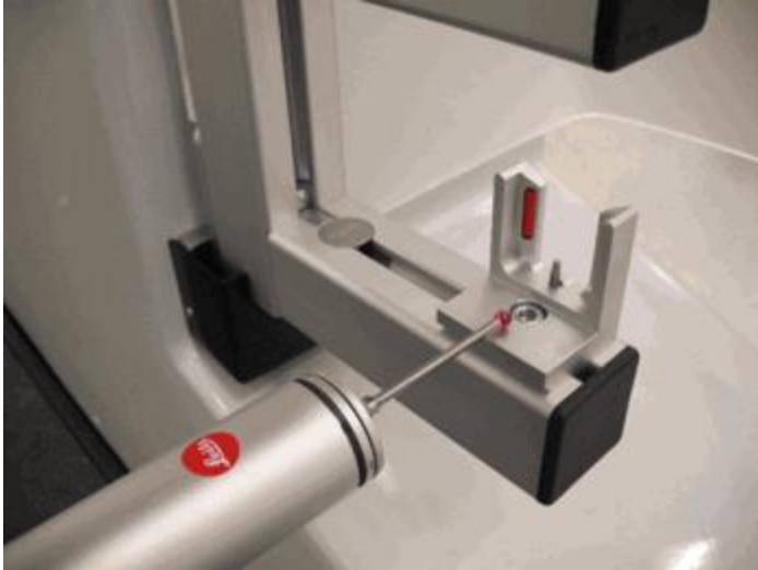
Palpage vertical sur la surface horizontale plate du port inférieur - vue 2
