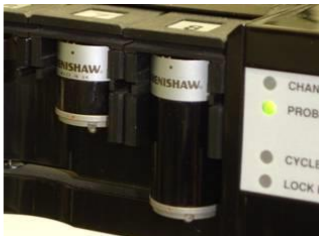
Changeur de palpeur ACR1 montrant deux extensions de palpeur différentes dans les ports 7 et 8
