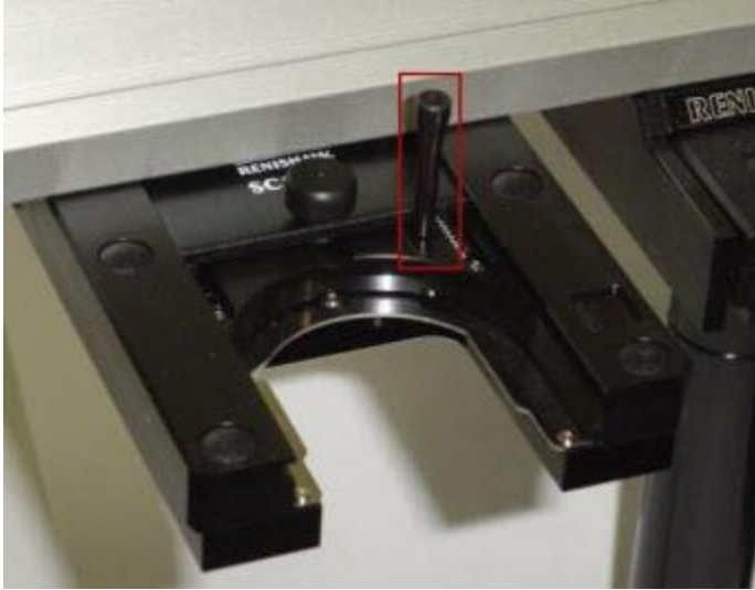
Exemple de changeur de palpeur SCP600 avec un port vide maintenu ouvert avec la clé de stylet
