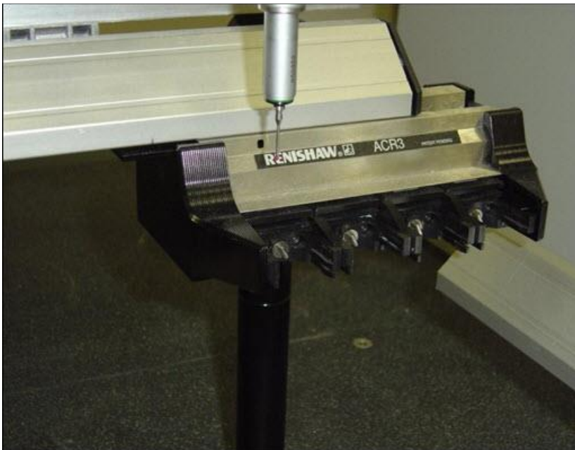
Exemple montrant le changeur de palpeur ACR3 du côté droit de sa plage de déplacement
