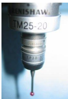
Module TM25-20 et stylet de type TP20
