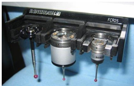
Insertions et types de palpeur pour le changeur de palpeur FCR25
