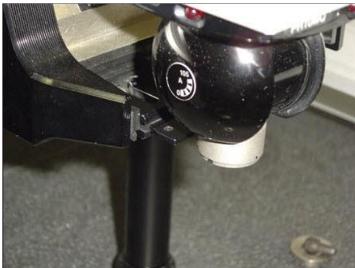
Exemple montrant le deuxième palpage manuel
