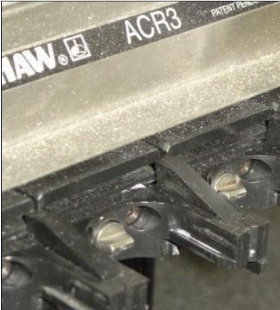
Exemple montrant des cales entre plusieurs ports adjacents
