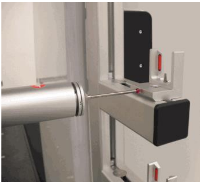
Palpé horizontal sur la surface avant verticale plate du port supérieur
