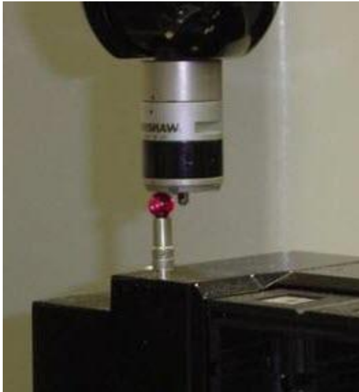
Exemple montrant le palpage manuel au bas de chaque PEM
