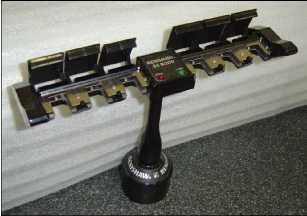
Exemple montrant les capots des ports ouverts avant le calibrage
