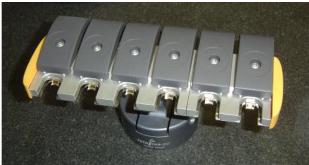
Exemple montrant les capots des ports ouverts avant le calibrage
