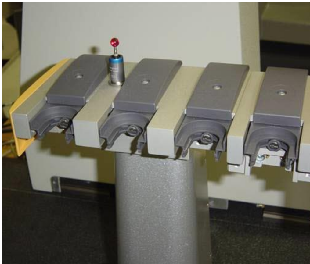
Exemple montrant les capots des ports ouverts avant le calibrage
