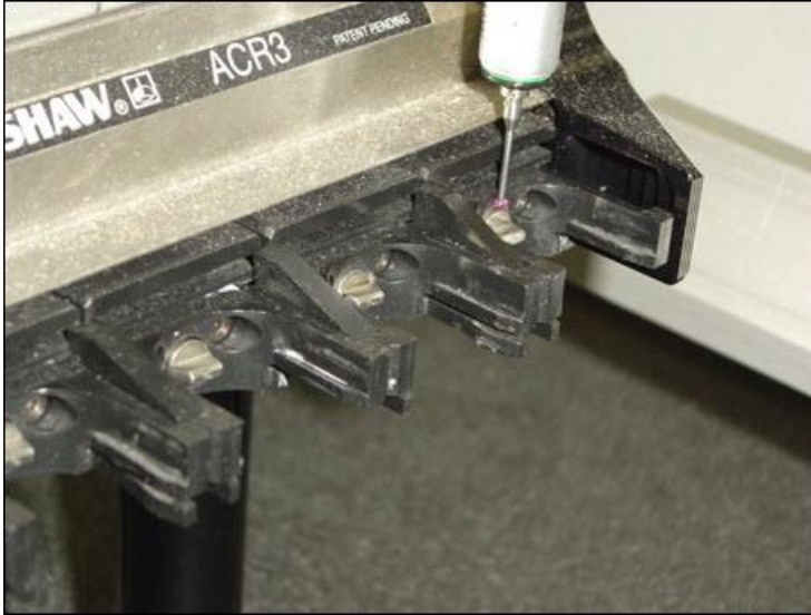
Exemple montrant le deuxième palpement manuel dans l'arrière du port 4
