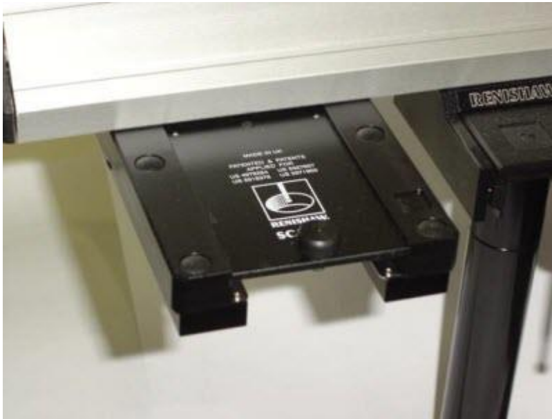
Support de changeur de stylet Renishaw SCP600
