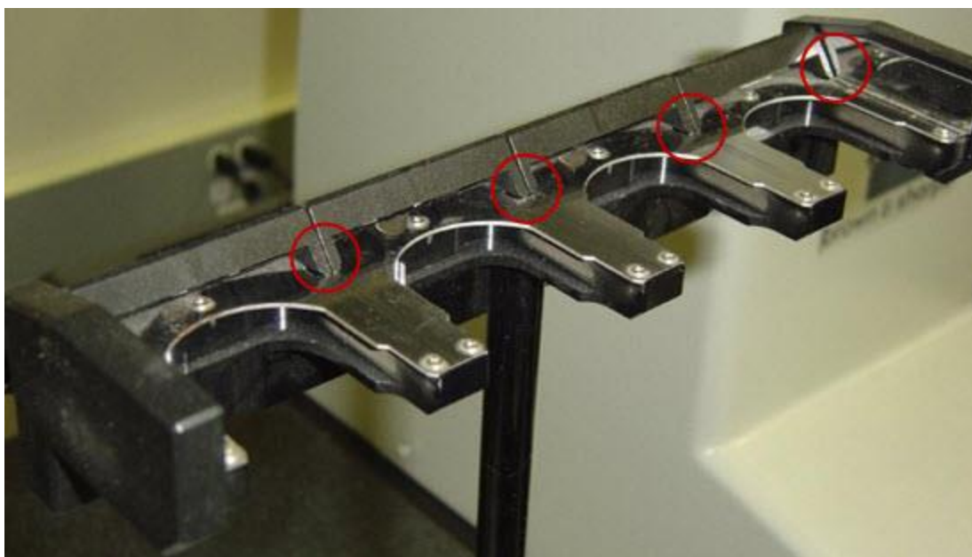
Changeur de palpeur SP600 montrant des ports vides maintenus ouverts par des extensions plastiques de chaque côté du capot du port, qui glissent dans les trous correspondants de la surface du support (indiqués par les cercles rouges)
