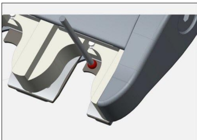
Vue du quatrième palpement sur la surface supérieure de la tablette de support du palpeur à l'arrière du port
